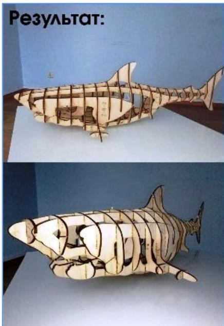
Далее Елисей создал 3D-модель светильника в программе SlicerforFusion360, которая дает возможность «разрезать» модель, как угодно – вдоль, поперек и 3D-модель превращается в замечательный арт-объект! Но благодаря этому модель можно распилить на части, то есть вырезать составляющие из любого материала, например, из фанеры.
